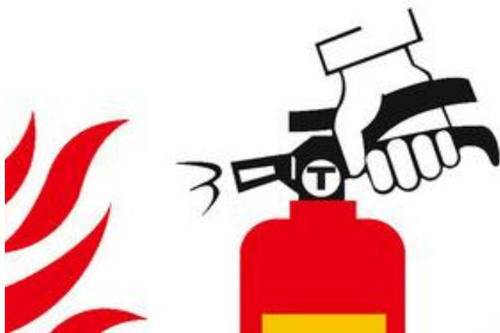
右手提着灭火器压把，快速来到着火点。在距火焰两米的地方，右手用力压下压把，左手拿着喷管左右扫射，喷射干粉覆盖燃烧区，直至把火全部扑灭。
